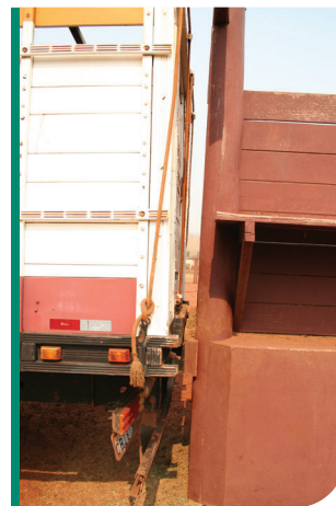
DEVE-SE EVITAR ESPAÇOS ENTRE A GAIOLA E O EMBARCADOURO.
